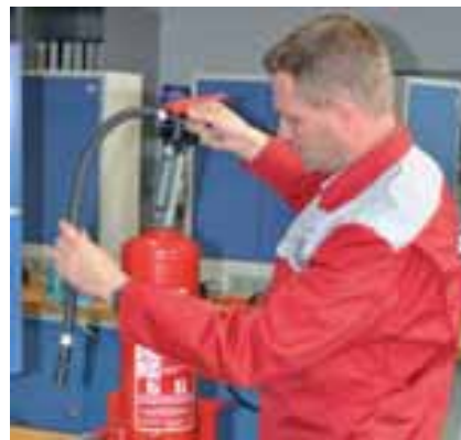
Paineettoman käsisammuttimen purkaminen.
