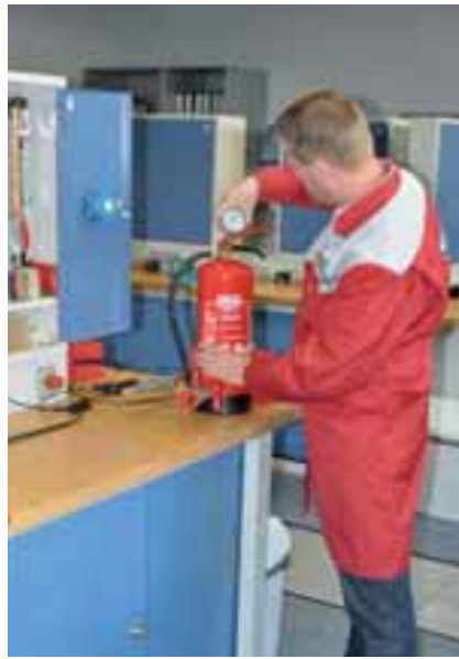
Käsisammuttimen paineentarkastus tehdään erillisellä mittarilla paineellisille sammuttimille.
