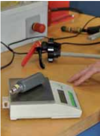
Paineettoman käsisammuttimen ponnepullon täytös tarkastetaan punnitsemalla.
